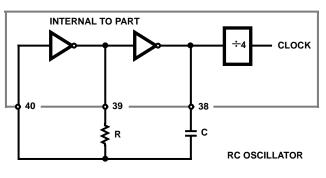
FIGURE 9. CLOCK CIRCUITS
