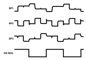
FIGURE 9. TYPICAL BACKPLANE AND ANNUNCIATOR DRIVE WAVEFORMS
