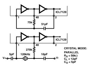
FIGURE 12. RC AND CRYSTAL OSCILLATOR CIRCUITS
