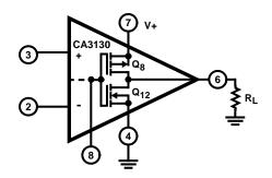
FIGURE 6B. SINGLE POWER SUPPLY OPERATION
