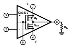
FIGURE 6A. DUAL POWER SUPPLY OPERATION
