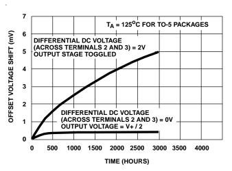
FIGURE 5. TYPICAL INCREMENTAL OFFSET-VOLTAGE SHIFT vs OPERATING LIFE
