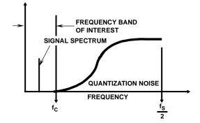
FIGURE 7C. OVERSAMPLED 1ST ORDER SIGMA DELTA QUANTIZATION NOISE SPECTRUM
